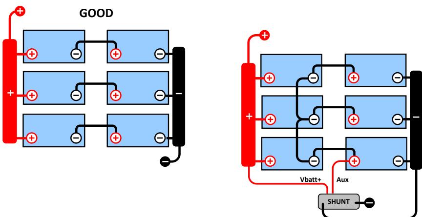
In einer unüberwachten Batteriebank sollten die Mittelpunkte nicht miteinander verbunden sein, eine schlechte Batteriebank kann unbemerkt bleiben und alle anderen Batterien beschädigen.
