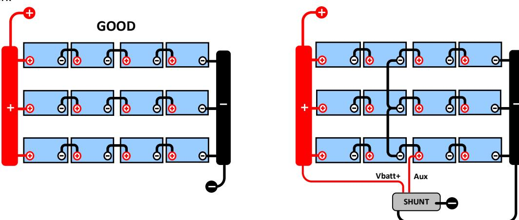
In einer unüberwachten Batteriebank sollten die Mittelpunkte nicht miteinander verbunden sein, eine schlechte Batteriebank kann unbemerkt bleiben und alle anderen Batterien beschädigen.
