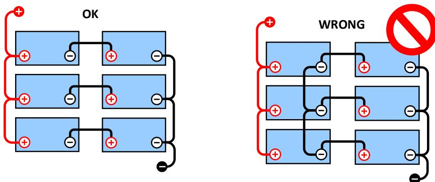
Aufgrund des Spannungsabfalls über das positive und das negative Kabel sind die Mittenspannungen nicht identisch.
