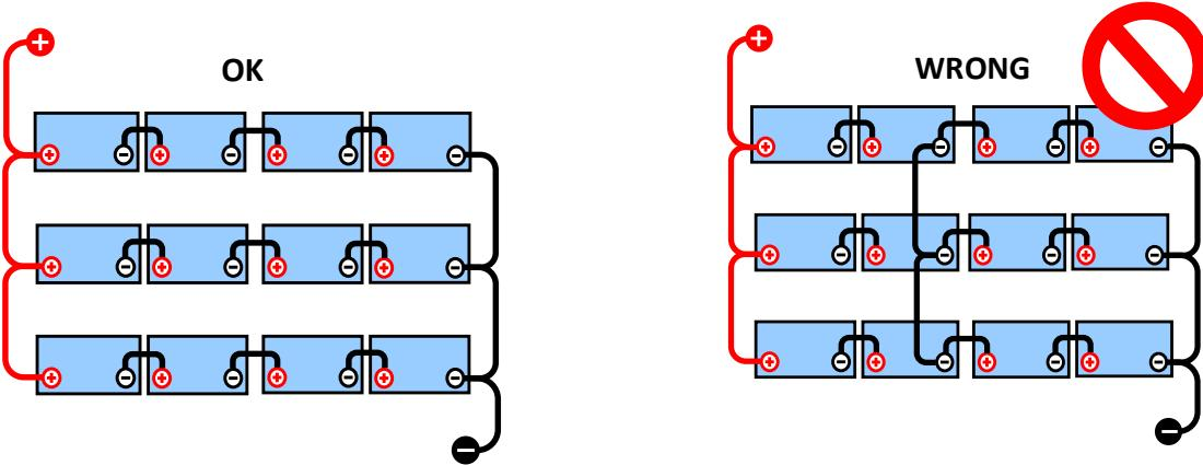
På grund av spänningsbortfall över de positiva och negativa kablarna är mittzonspänningarna inte identiska.
