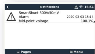
Tenere presente che, diversamente dalla serie di monitor della batteria BMV, lo SmartShunt non possiede un relè di allarme o un cicalino. Se fosse necessaria una funzione relè, collegare lo SmartShunt a un dispositivo GX e utilizzare il relè di tale dispositivo GX, associandolo alla funzione dello SmartShunt.
