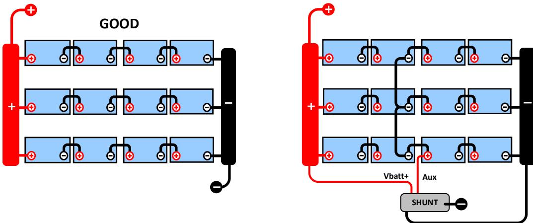
I en oövervakad batteribank bör inte mittzonerna länkas samman, en dålig batteribank kan missas och skada alla de andra batterierna.
