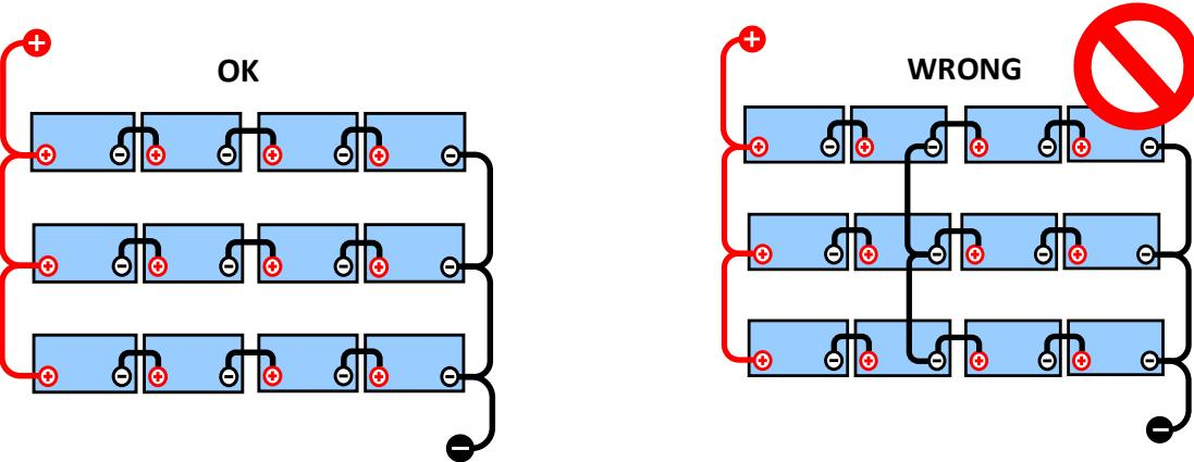
En raison de la chute de tension sur les câbles positif et négatif, la tension du point médian n'est pas identique.
