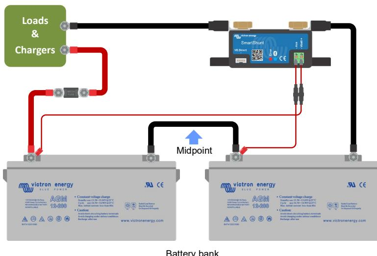
Für weitere Informationen zur Mittelpunktsüberwachung siehe Kapitel 9. Dieses Kapitel enthält auch Informationen und Schaltpläne zur Überwachung des Mittelpunkts von Batteriebanken, die in Reihe/parallel verdrahtet wurden.
