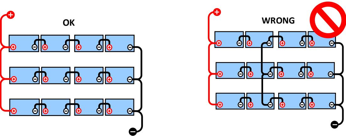
Debido a la caída de tensión en los cables positivo y negativo, las tensiones del punto medio no son idénticas.
