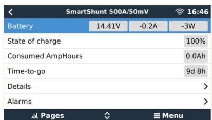
Lo SmartShunt può essere collegato a un dispositivo GX mediante un cavo VE.Direct, numero di serie ASS03053xxxx. I cavi VE.Direct sono disponibili con lunghezze variabili da 0,3 a 10 metri e con connettori lineari o ad angolo retto. Al posto di utilizzare un cavo VE.Direct, lo SmartShunt di può collegare a un dispositivo GX anche tramite l'interfaccia VE.Direct a USB.
