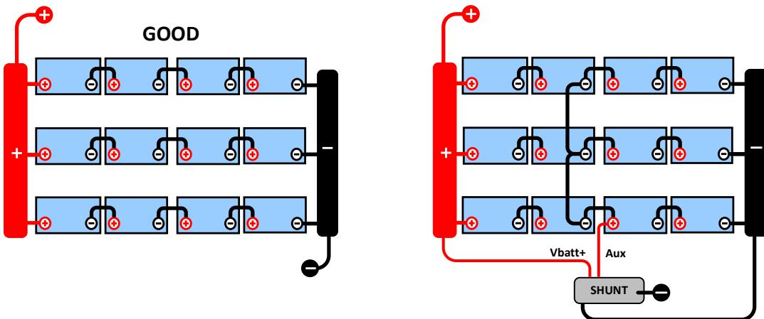
Dans le cas d'un banc de batteries non supervisé, les points médians ne devraient pas être connectés entre eux : un mauvais banc de batteries peut passer inaperçu et endommager toutes les autres batteries.
