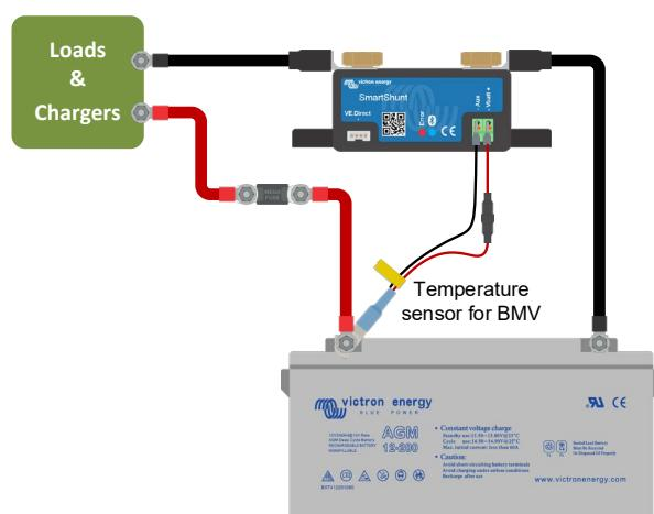
Veuillez noter que vous utilisez la sonde de température, les câbles d'alimentation rouges qui proviennent du SmartShunt ne sont pas nécessaires. La sonde de température remplacera ces câbles.
