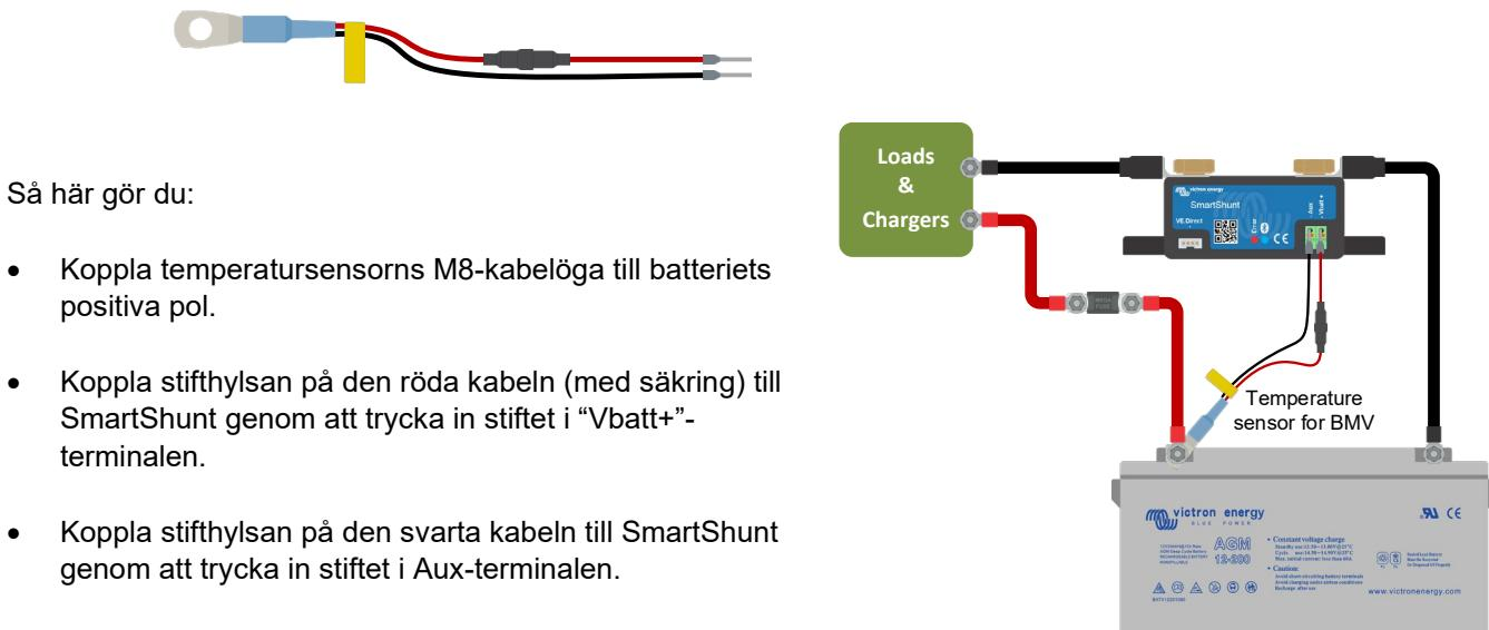
Observera att de röda strömkablarna som följer med SmartShunt inte behövs om du använder temperatursensorn. Temperatursensorn ersätter dessa kablar.
